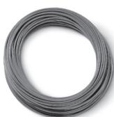
Трубопровод FER из сополимера тетрафторэтилена и гексафторпропилена имеет физико-механические характеристики, подобные PTFE, но отличается более высокой кристалличностью, прозрачностью и отсутствием микропористости. Применяется в пищевой промышленности. Соответствует требованиям FDA 21 CFR 177.1550, регламентам EU 1395/2004 и EU 10/2001.
